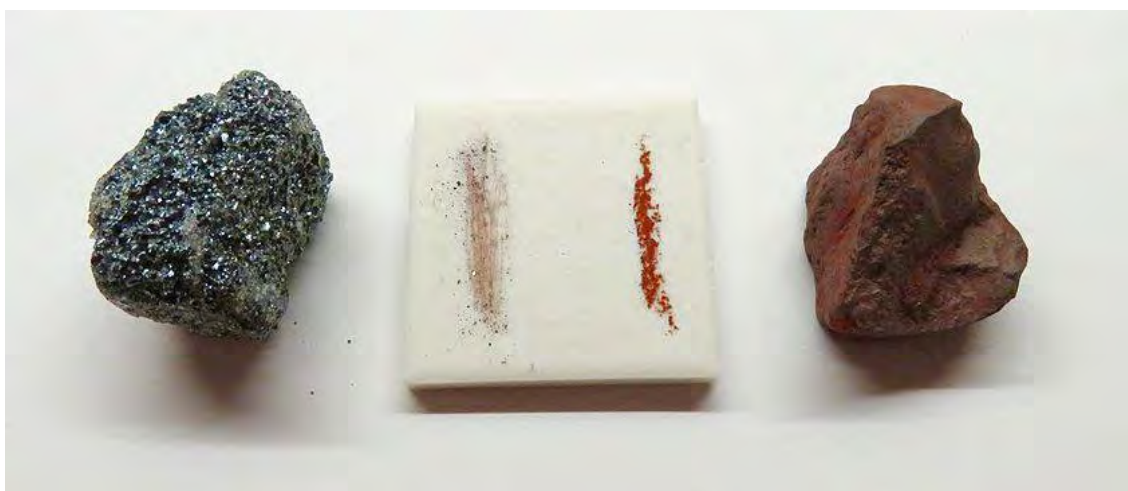
Рис. 3.9. Визначення кольору риски
